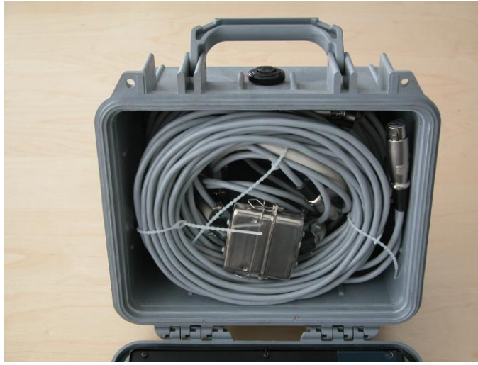
Inneraum zur Lagerung der Verbindungskabel.
